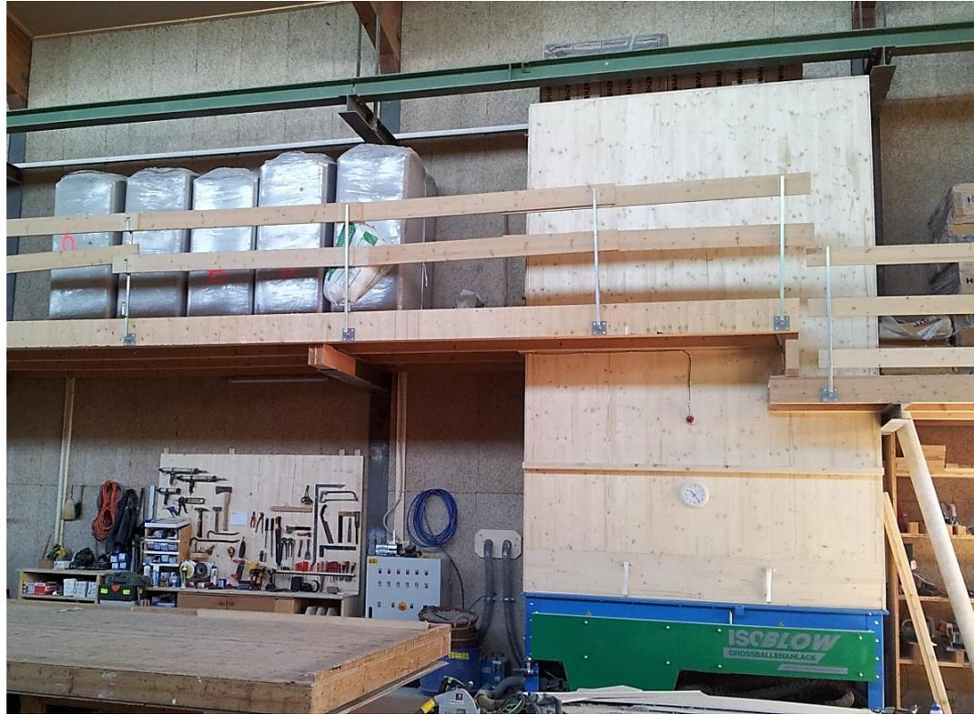
Über eine Zwischendecke werden bis zu 4 Großballen à ca. 300 kg in die Anlage gekippt.
