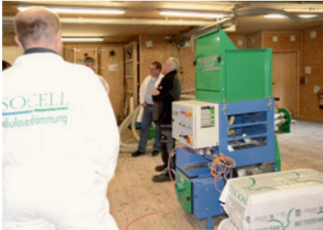
Les participants peuvent directement sur place mettre la main à la pâte et apprennent ainsi concrètement la manipulation du matériau isolant en cellulose et des machines à insuffler.
