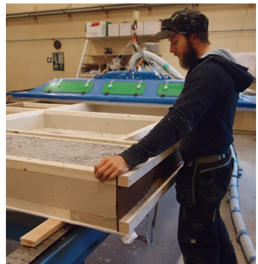
Bei Thornaldehyus arbeitet man seit 2014 mit modernster Einblastechnologie in der Vorfertigung von Holzriegelkonstruktionen.
