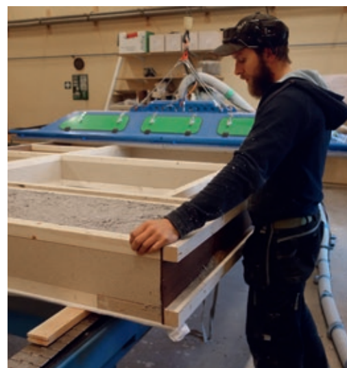
Depuis 2014, Thornaldehy utilise une technique d'insufflation de pointe dans le processus de préfabrication des constructions à ossature de bois.
