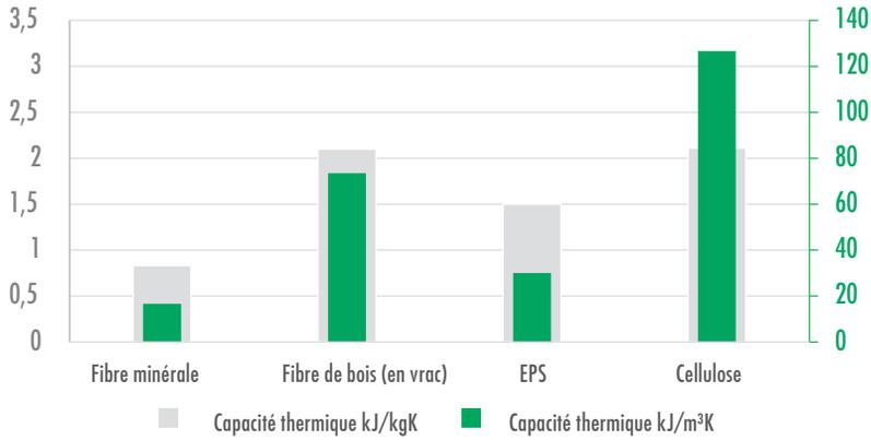
Les colonnes vertes du diagramme indiquent la quantité d'énergie absorbée  $m^3$  de matériau d'isolation lorsqu'il est chauffé par un degré Kelvin.
