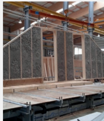
Die Fasern verfilzen sich im Bauteil zu einer maßgeschneiderten Dämmmatte.
