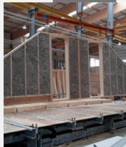
Les fibres s'emmêlent dans le caisson pour former un tapis d'isolation sur mesure.
