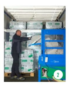
Un aiutante riempie la macchina soffiatrice nell'autocarro con l'isolamento cellulosico ISOCELL.
