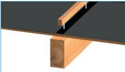
Gemäß der SIA Norm 232, ZVDH- Merkblatt sowie der ÖNORM B 4119 sind bei erhöhter Anforderung die Konterlatten immer mit den ISOCELL Nageldichtungen abzudichten. Zum Beispiel mit dem OMEGA NDB Nageldichtband oder ab einer Dachneigung  $\geq 5^\circ$  PE-Nageldichtband DSK. Die Verwendung korrosionsbeständiger Befestigungsmittel wird empfohlen.
