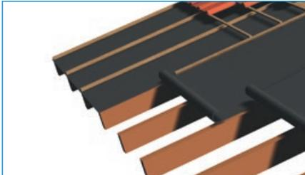
Bei Ausführung einer Unterspannung empfehlen wir, die Überlappungsstöße über dem Sparren vorzusehen. Der freie Wasserabfluss muss sichergestellt werden.
