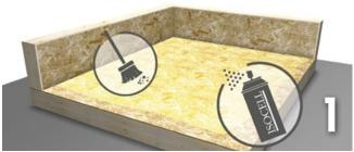
Die Untergründe sind bei kalten Temperaturen sowie bei mangelnder Tragfähigkeit vorzubehandeln. Die beste Haftung am Untergrund wird in Verbindung mit ISOCELL Primern erreicht. Hierfür eignen sich besonders gut der UNI SPRAY Sprühprimer bzw. der UNI XL Sprühprimer.
