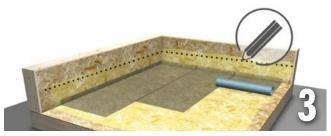
Es ist empfehlenswert die gewünschte Höhe (z. B. Oberkante der Wärmedämmung) zu markieren, damit das Band in einer Linie verklebt werden kann. Die zu beklebende Fläche im Hochzugbereich mit dem UNI SPRAY Sprühprimer bzw. UNI XL Sprühprimer vorbehandeln und je nach Temperatur entsprechend ablüften lassen.
