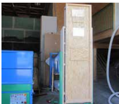
ISOCELL Zellulose auf dem Prüfstand - der „Rütteltest“
