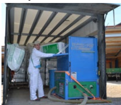
La machine à insuffler ainsi que les sacs de ouate restent dans le camion — économie de temps et de manutention pour le poseur.
