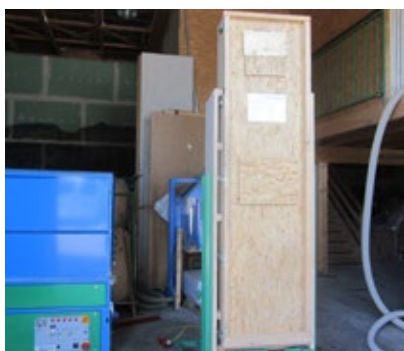
ISOCELL cellulose op de testbank – de trillingstest
